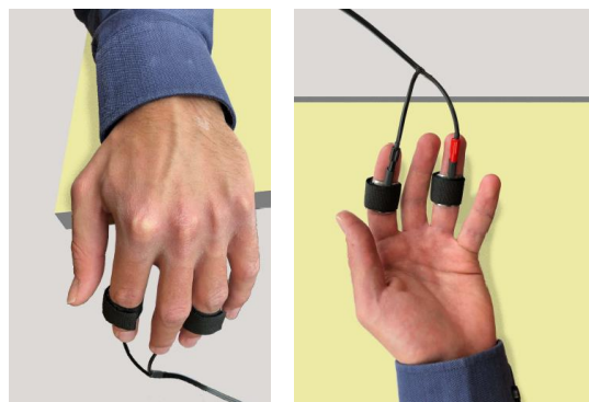
Abb. 28: Sensoren zur Messung der Hautleitfähigkeit an den Fingern der linken Hand. (Bilder: Jens Fischer 2019)
