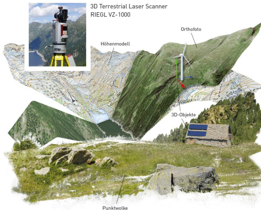
Abb. 24: 3D-Visualisierungsansatz basierend auf einer Kombination von Höhenmodellen, Orthophotos, LiDAR-Daten und 3D-Objekten. (Renderings: R. Spielhofer & U. Wissen Hayek 2018; Collage: R. Sonderegger 2018)
